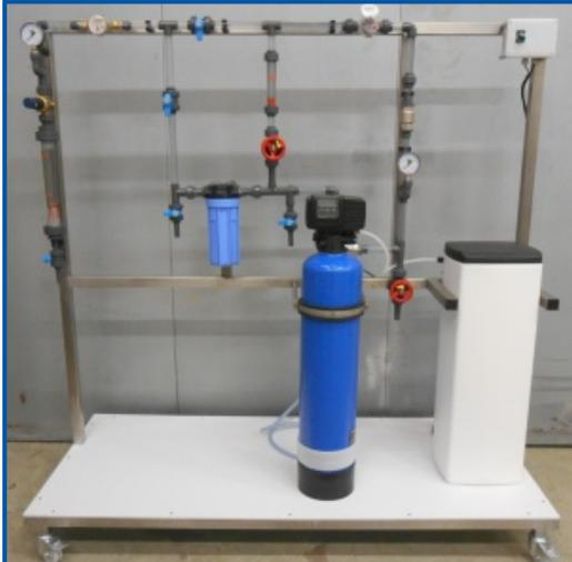
**A dureza da água depende principalmente da bacia hidrológica da região e da origem da água. A dureza da água é reduzida usando um amaciador de água que é escolhido de acordo com os diferentes modos de operação.**
